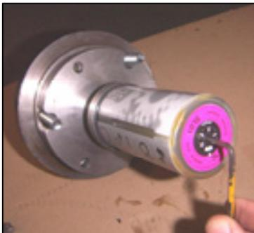
Avec une clé, régler le débit sur le repère 3 afin d'avoir un graissage optimal ; le graissage sera effectif pendant une période de 3 mois. Passé ce délai, il n'y aura plus de graissage.
