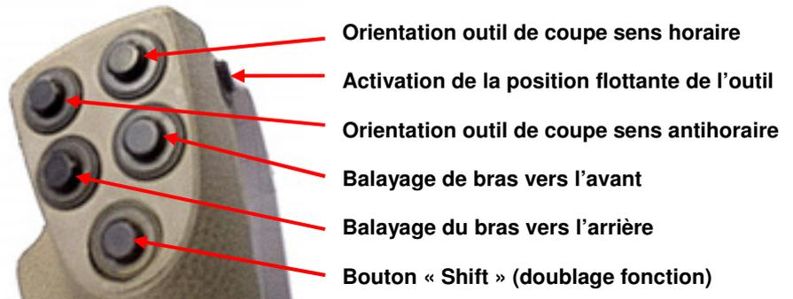
Les mouvements avant / arrière du mono-levier assurent les fonctions montée et descente du premier bras.
