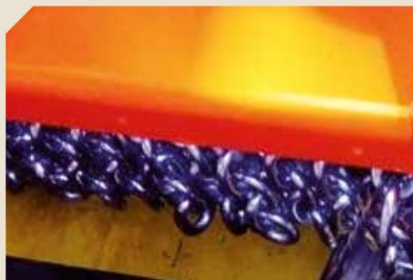
Protection avant par plaques/chaînes/caoutchouc.
