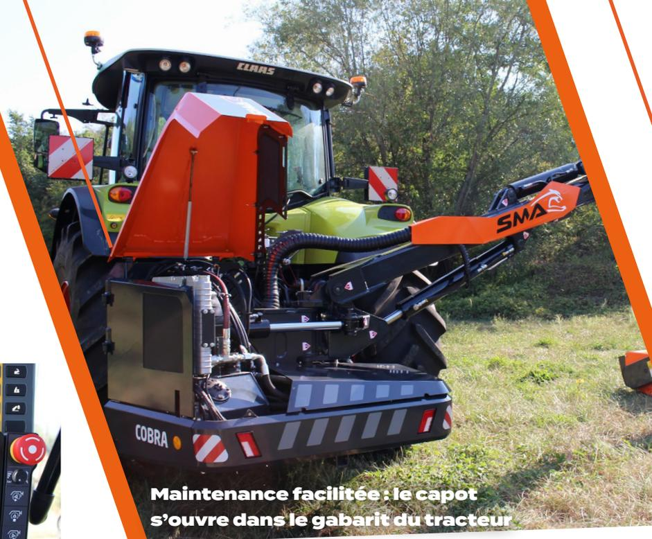
**Maintenance facilitée : le capot s'ouvre dans le gabarit du tracteur**
