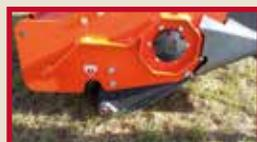
**PATIN EN OPTION :** patins mécano-soudés symétriques, plat en Hardox, pour fauchage raisonné 50 à 150 mm
