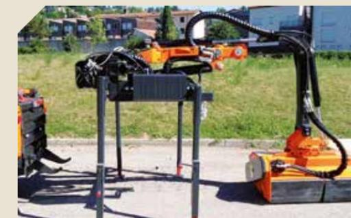
Châssis arrière à démontage rapide
