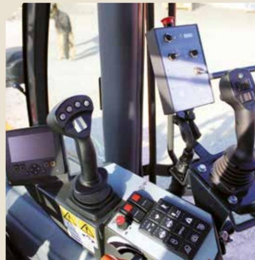
Ordinateur et joystick regroupés, clavier simple d'usage pour contrôler les fonctions de commande
